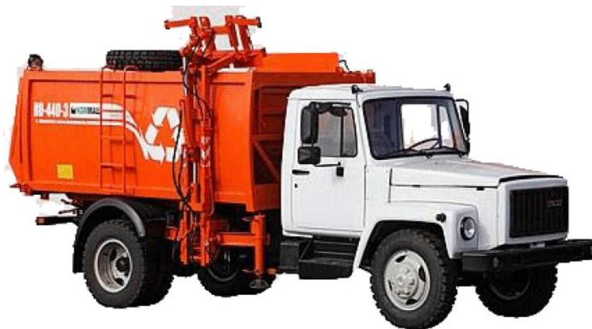
Рисунок 5.25. Кузовной мусоровоз КО-440-2 с боковой загрузкой кузова манипулятором.
